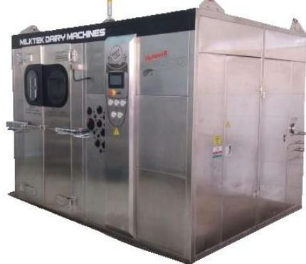
Kullanılan her türlü ürünün temizlenmesinde kullanılabilir. İmmersiyon sistemi, peynir kalıplarının temizlenmesi amacıyla kullanılır. Sistem; asit tankı, kostik tankı, su tankı, kafes taşıma arabası ve kafes sisteminden oluşmaktadır.
